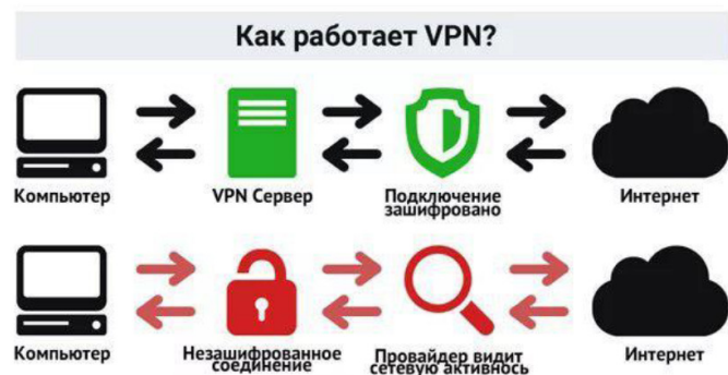
Сурет 3 – VPN жүйесінің жұмыс істеу схемасы
